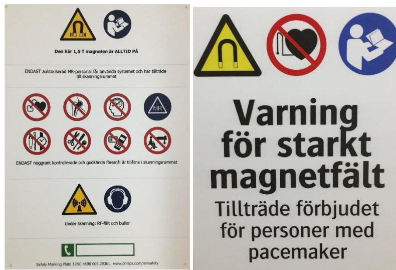
Figur 2 Skyltning av MR-zon varnar för förekommande elektromagnetiska fält, höga ljudnivåer och icke MR-kompatibla föremål.
